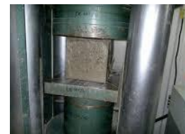
Rajah 11: Bahan tambah gentian sabut kelapa membantu menambah kekuatan kiub konkrit.
