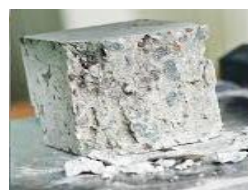
Rajah 11: Bahan tambah gentian sabut kelapa membantu menambah kekuatan kiub konkrit.
