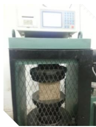
Rajah 7: Ujian kekuatan mampatan kiub konkrit
